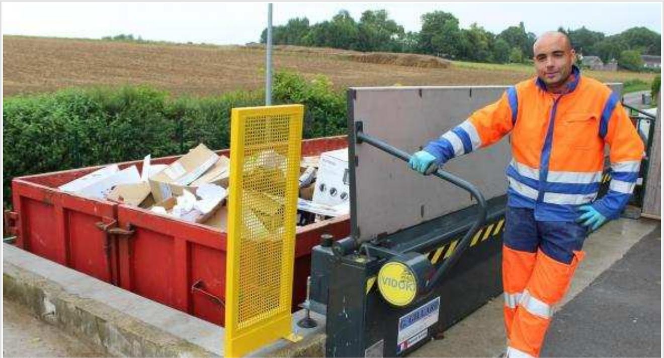
La nouvelle benne pour les cartons permet de tripler le poids en les compactant.
