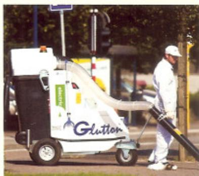
Petite machine dont le but est d'améliorer les conditions de travail du balayeur de rue. Avec une propulsion grâce à un moteur thermique, le Glutton® roule à côté de l'homme qui le commande, en répondant parfaitement à ce que lui fait faire l'agent de la propreté.
