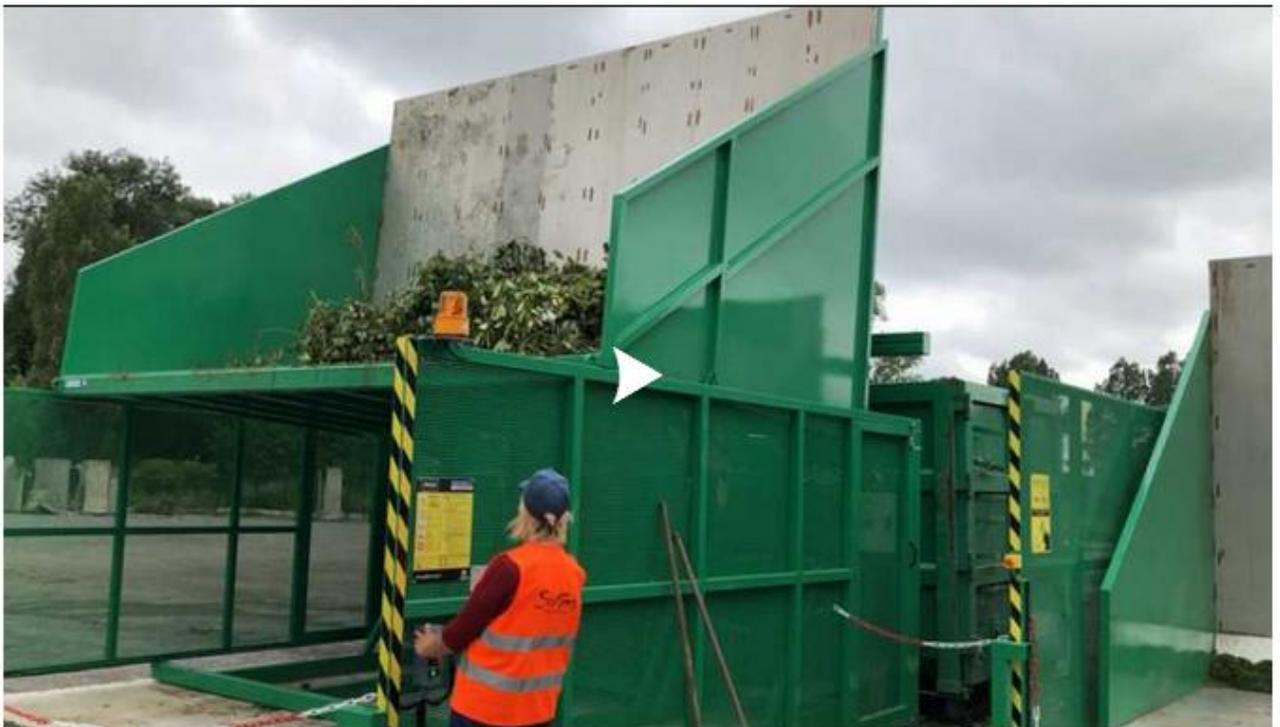
Le fonctionnement de ces bennes est simple : le conducteur recule son véhicule et dépose ses déchets verts sur une plateforme. L'employé du Sirtom actionne ensuite cette plateforme pour faire passer les déchets verts dans la benne.
