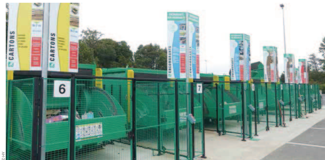
Chacun des six compacteurs Ork de 30 m 3 reçoit un flux clairement signalé.
