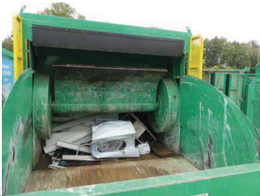
Les bennes Ork collectent, stockent et compactent tous types de déchets, même la ferraille.
