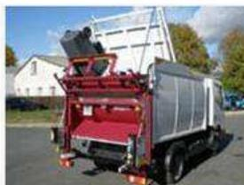
Il costruttore di mezzi e attrezzature per il trattamento dei rifiuti GILLARD ha realizzato e brevettato una benna per la raccolta dei rifiuti di nuova concezione. Per il suo concetto brevettato della massima sicurezza per l'operatore, abbinato alla garanzia, la benna Kalypso per veicoli leggeri rappresenta la soluzione ottimale per la raccolta dei rifiuti manuale o in container in strade strette e nei piccoli agglomerati urbani e nei centri storici.
