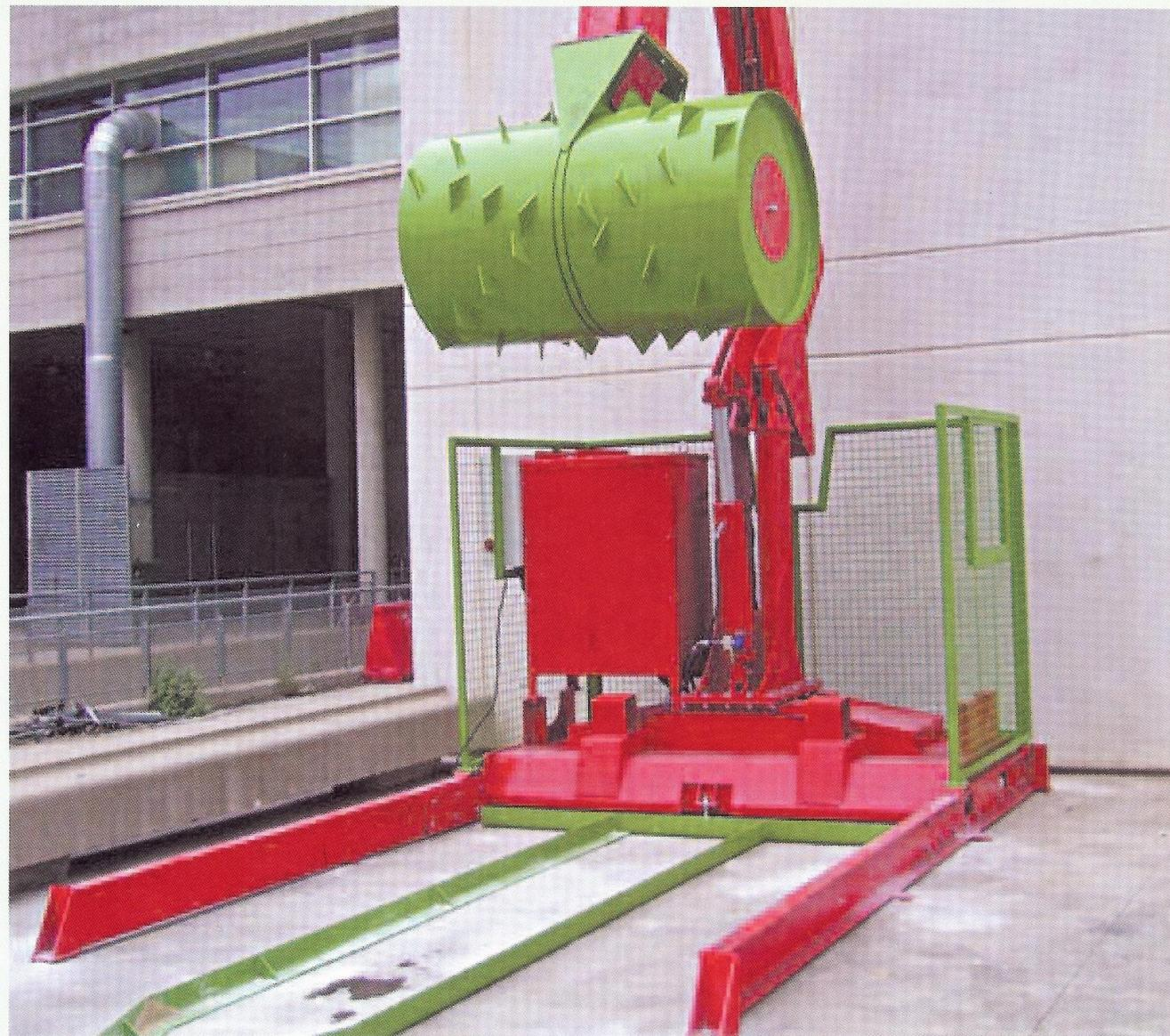
*Électrique, le compacteur fixe à rouleau Krak de Gillard peut être réglé précisément afin de ne pas endommager la benne, notamment sa face avant.*
