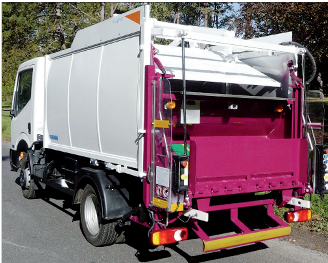
Benne de collecte compacte pour véhicules légers. Photo D.R
