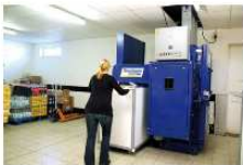
Avec la presse à cartons AutoLoadBaler de l'Allemand Strautmann, le chargement est automatique et les balles générées sont plus denses. © DR
