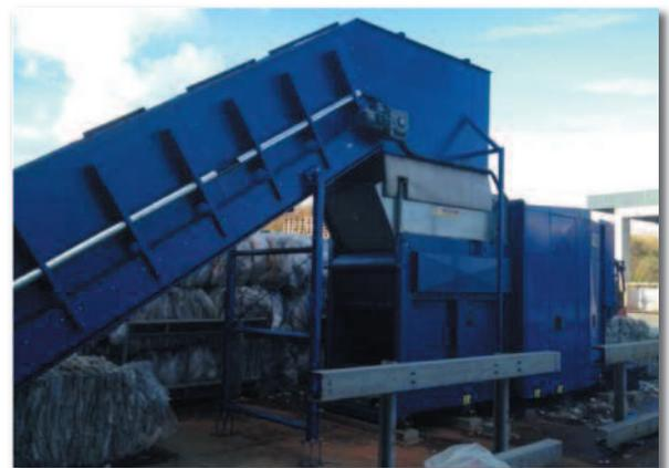
Implantation extérieure, chargement avec convoyeur pour bouteilles PET
