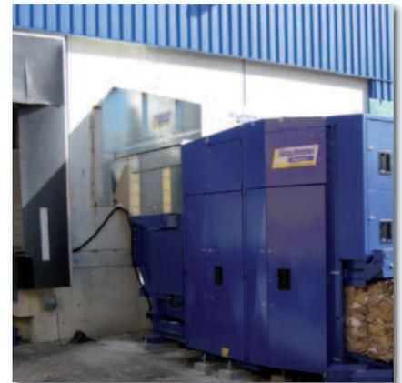
Implantation extérieure, chargement avec trémie tunnel
