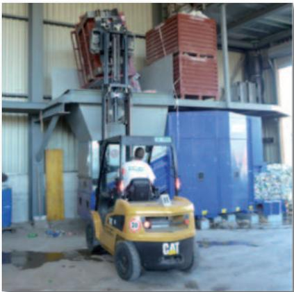
Installation avec une trémie pour chargement au chariot élévateur
