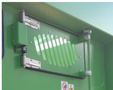
Trappe de débouillage sécurisée
