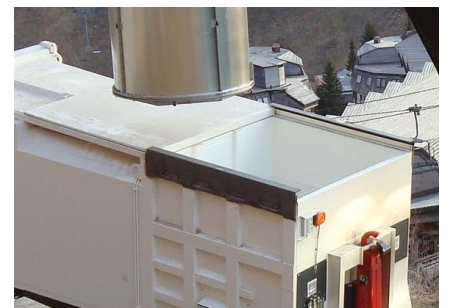
Volets de fermeture hydrauliques pour éviter l'envol des déchets
