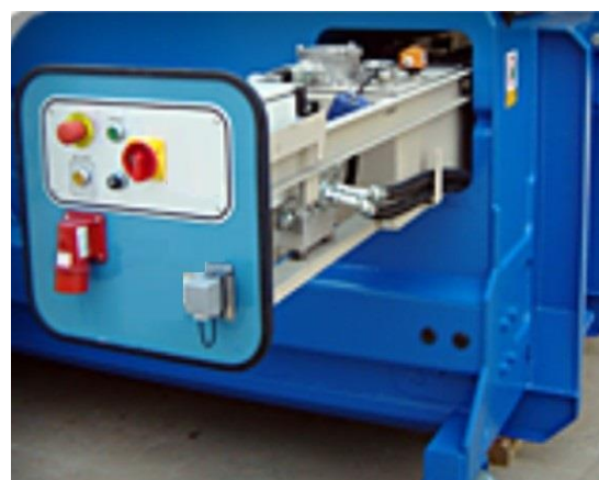
• Groupe électro hydraulique sur tiroir coulissant
