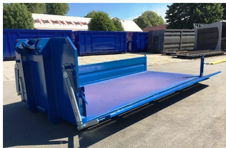
Assistance des ridelles pour lever/ baisser par ressorts
