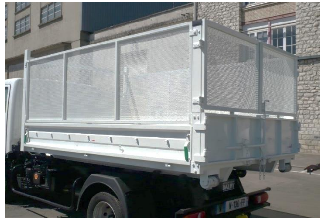
Réhausses grillagées sur portes
