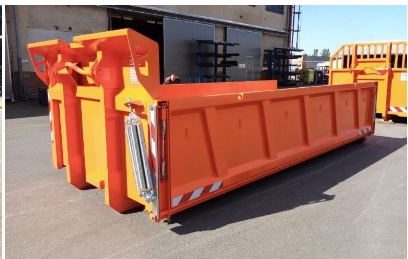
Assistance des ridelles pour lever/ baisser par ressorts
