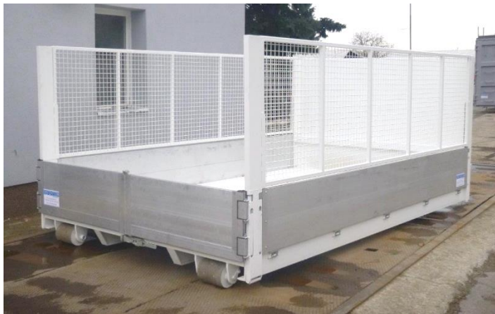
Ridelles en aluminium et réhausses grillagées
