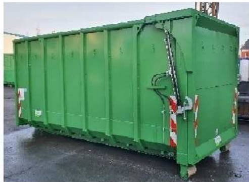
• Benne porte arrière hydraulique étanche articulée par le haut
