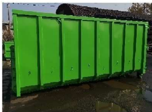
• Benne 30m 3 - Vue de côté
