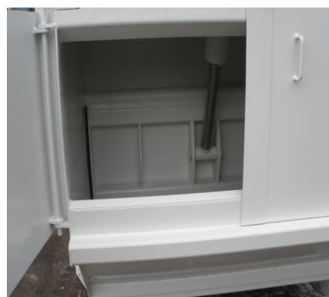
• Bouclier en compaction
