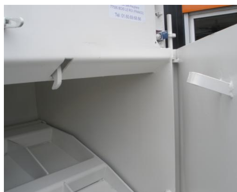
• Verrou mécanique bloquant l'ouverture des portes d'accès lors des phases de compaction
