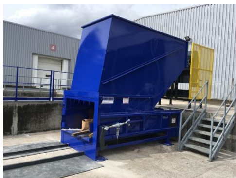
• i3 - 1500 chargement à quai, centrale hydraulique déportée
