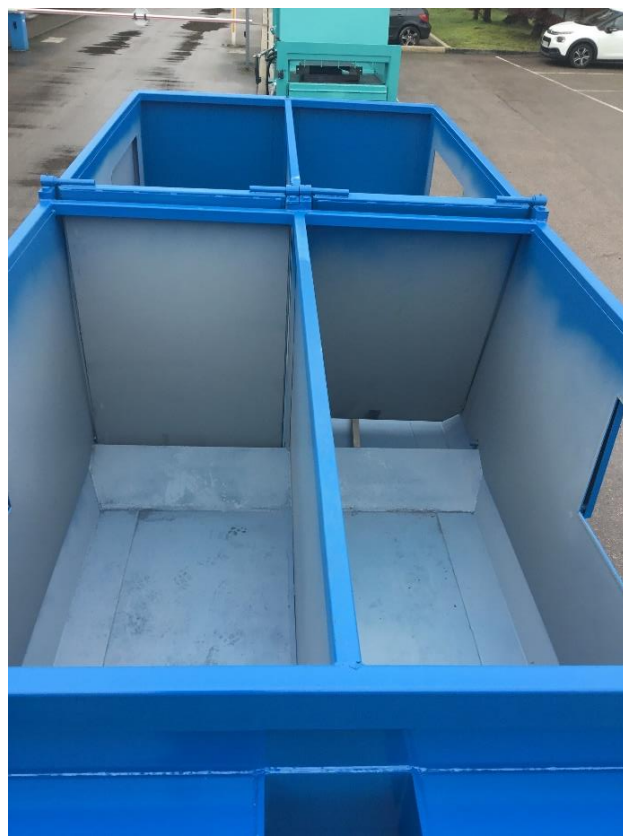
Vue du dessus des cloisons de séparation.
