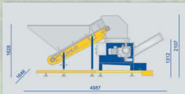
Trémie avec convoyeur et machines montées sur bacs de rétention (pompe optionnelle)
