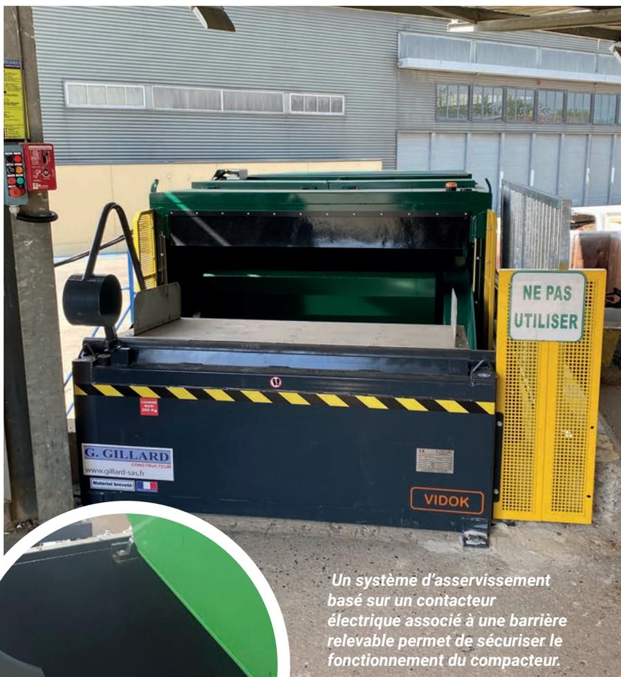
*Un système d'asservissement basé sur un contacteur électrique associé à une barrière relevable permet de sécuriser le fonctionnement du compacteur.*
