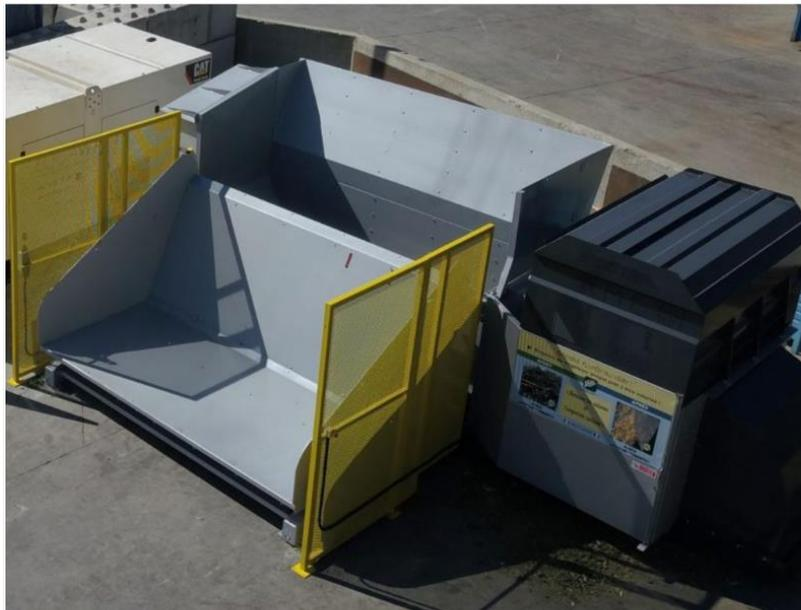
Le brevet déposé porte sur l'adjonction d'un godet au broyeur ce qui confère à la machine des atouts décisifs : chargement facile, pré-contrôle des dépôts, sécurité maximale (protection contre les projections...)
