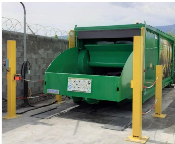
Le godet de 4 m 3 de capacité permet un remplissage optimisé, en toute sécurité, depuis le sol.
