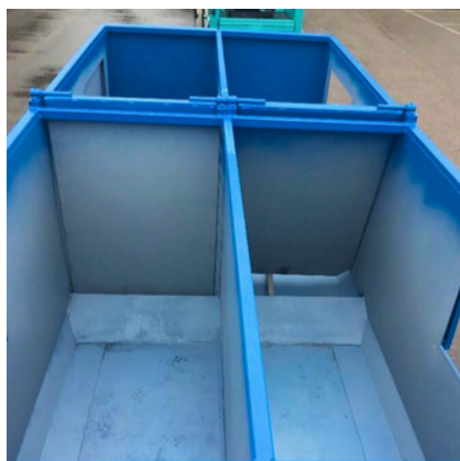
Vue du dessus des cloisons de séparation
