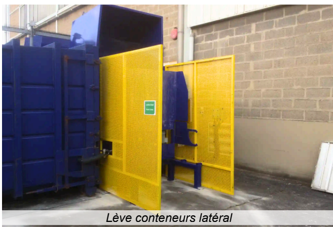
Lève conteneurs avec pesée et contrôle d'accès
