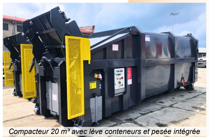
Compacteur 20 m 3 avec lève conteneurs intégré frontal
