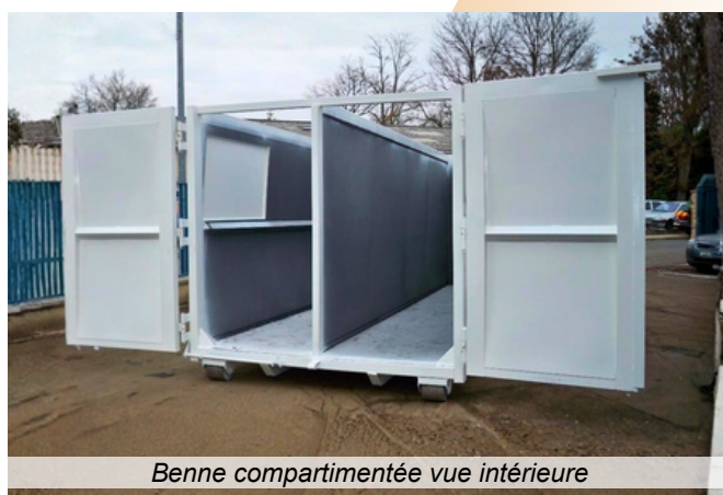
Benne ROK 20 m 3 compartimentée avec trappes latérales
