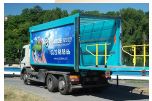
Benne KARGO (benne amovible avec hayon élévateur)
