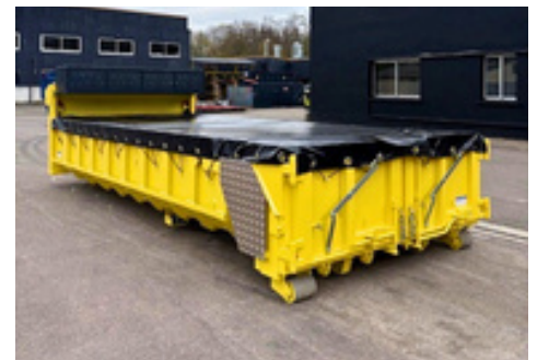
Benne TP porte arrière hydraulique et trappes
