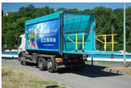
Benne amovible avec hayon élevateur 2 tonnes
