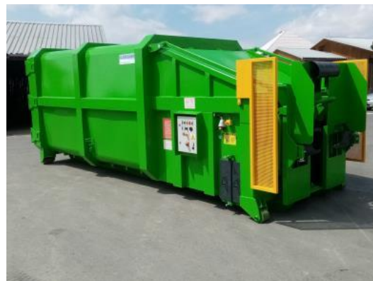
Lève conteneurs intégré frontal et capot asservi
