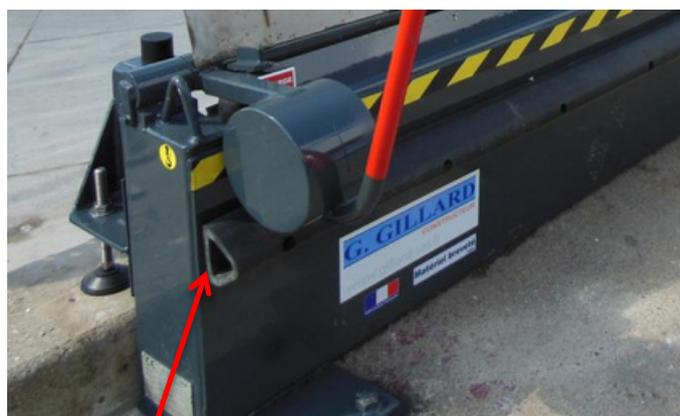
Tampon caoutchouc anti chocs/véhicules
