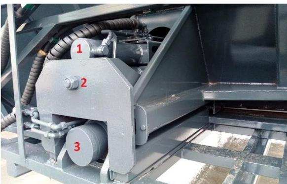
Détails de la fixation des vérins de poussée
