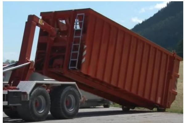
EJEKTOR en phase dépose
