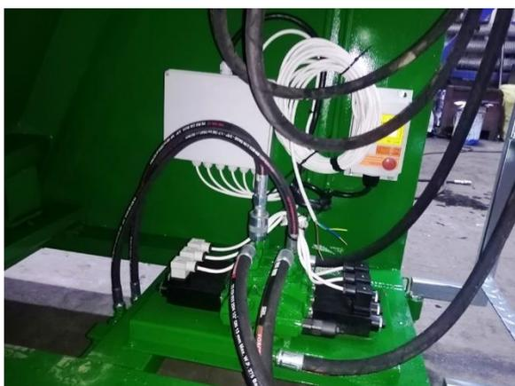
Armoire électrique et distributeur hydraulique
