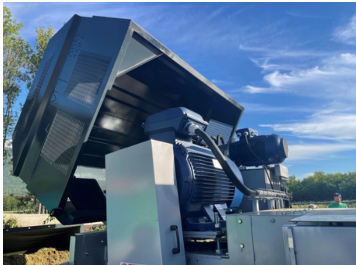
Moteur électrique et centrale hydraulique protégés par capot
