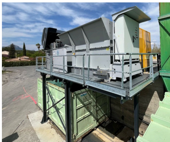
Passerelle de maintenance, version à quai
