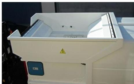
Option : Volets de fermeture hydrauliques pour éviter l'envol des déchets dans les phases de roulage
