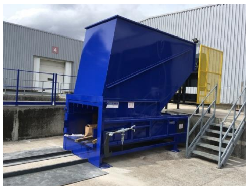
• i3 - 1500 chargement à quai, centrale hydraulique déportée
