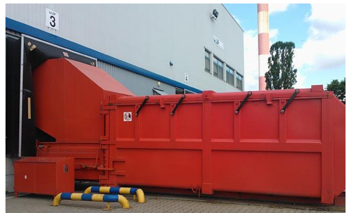
Compacteur à quai avec centrale hydraulique déportée pour abaissement du niveau de chargement
