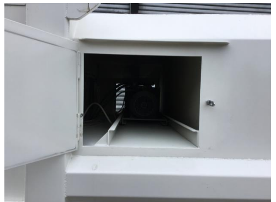
• Centrale hydraulique sur chassis coulissant de droite à gauche pour une meilleure ergonomie
