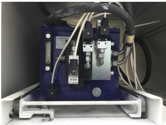
• Centrale hydraulique sur chassis coulissant de droite à gauche pour une meilleure ergonomie
