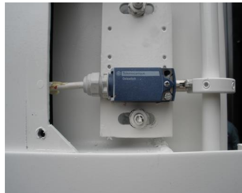
• Contacteur électrique empêchant le fonctionnement du compacteur porte ouvertes
