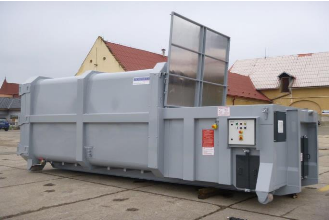
• Capot assisté par contre poids pour ouverture à 90°
