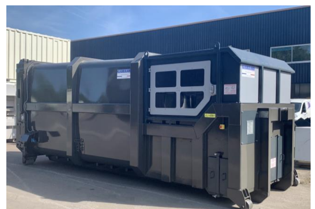
• Compacteur pour chargement manuel avec Trappe latérale sécurisée
