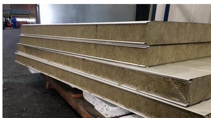
Les panneaux utilisés pour la réalisation de l'habillage sont d'une épaisseur de 100mm, répondant ainsi au minima de 1,5 mm.
