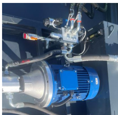
• Centrale hydraulique et armoire électrique sur le toit
