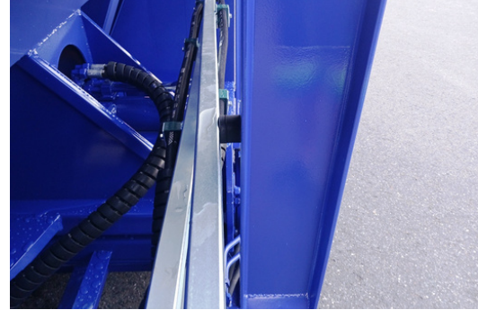
Alimentation hydraulique des flexibles de poussé
