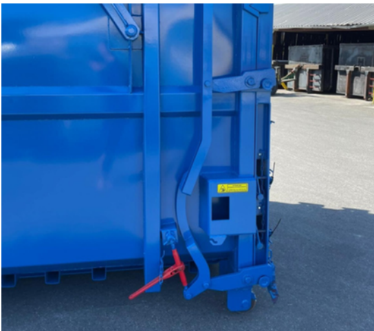
Système d'ouverture de la porte
