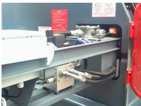
Coffret électrique et centrale hydraulique sur tiroir coulissant
