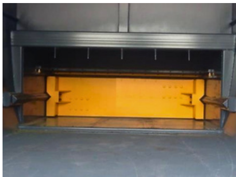
Vue intérieure : grande pénétration du bouclier et guidage latéral
