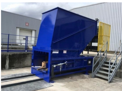
I3 1500 avec chargement à quai et centrale hydraulique déportée
