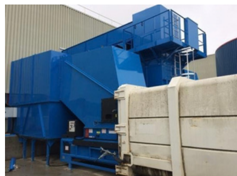
2 compacteurs I3 avec trémies et tapis de chargement
